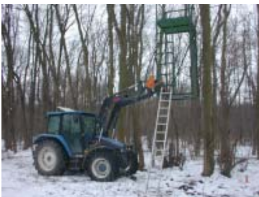
2.3.2004, auf einem Traktor wurden ein Metallgerüst als Arbeitsplattform montiert; damit konnten einzelne Astpartien bis in einer Höhe von 8 – 10 m entfernt werden.
